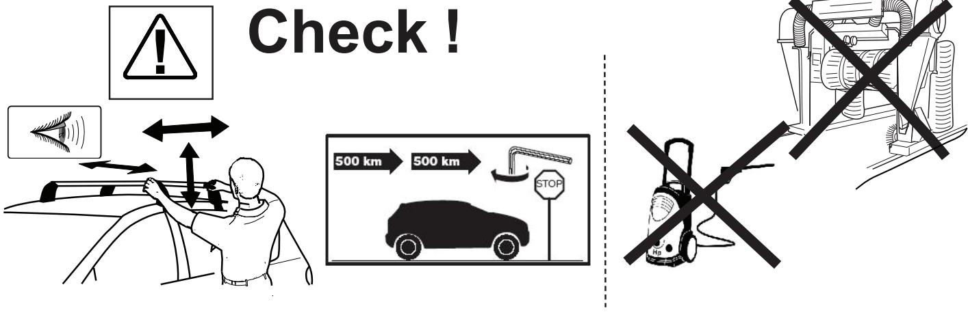
**D** Kontrolliere die Lastenträgerbefestigung, indem dieser kräftig nach vorne und hinten gedrückt wird. Die Befestigung des Lastenträgers während der Fahrt in regelmäßigen Abständen kontrollieren. Den Lastenträger immer mit dem Schlüssel abschliessen.
